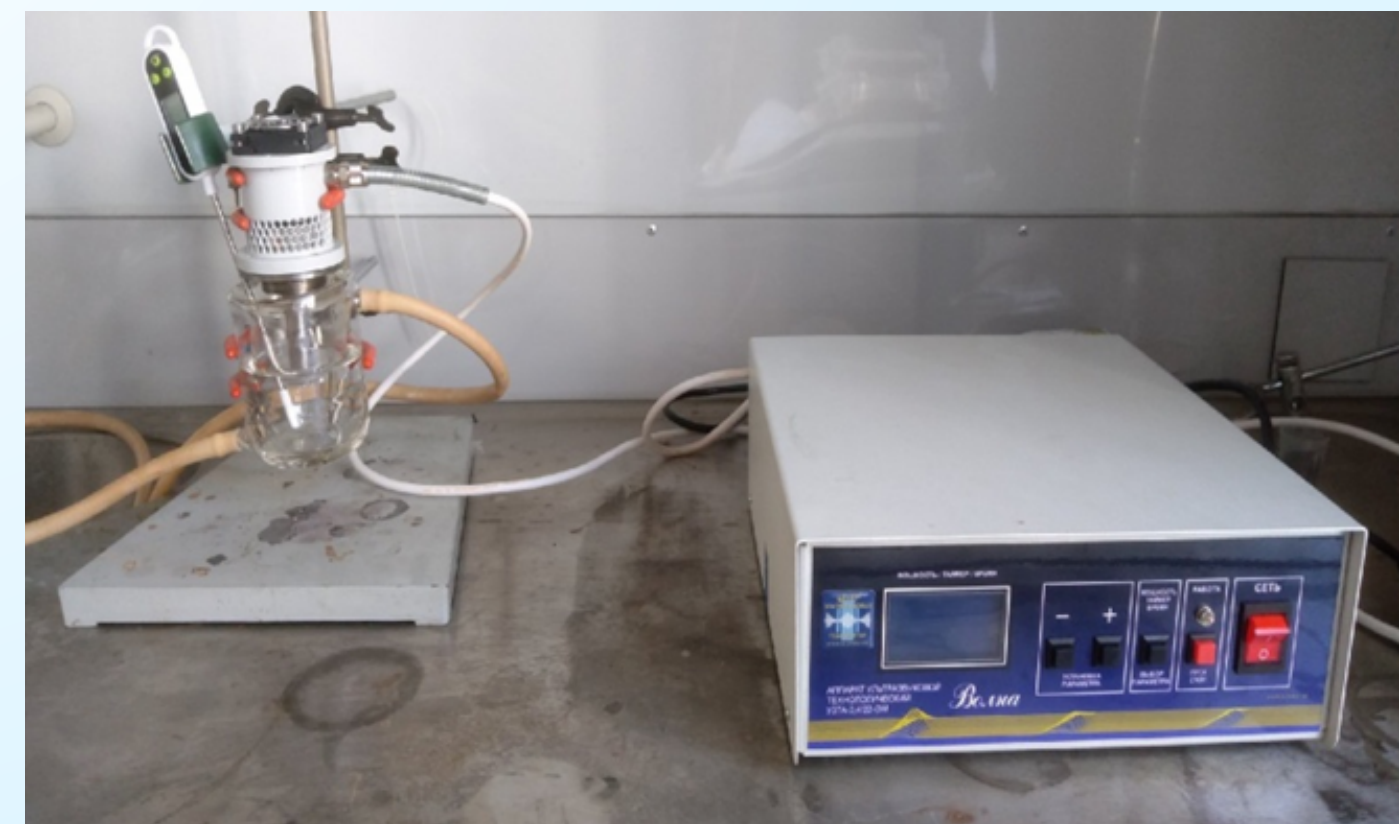
Рисунок 1 - Рабочая установка с ультразвуковым технологическим аппаратом «Волна», модель УЗТА – 0,4/22-ОМ, на которой проводились экспериментальные исследования
