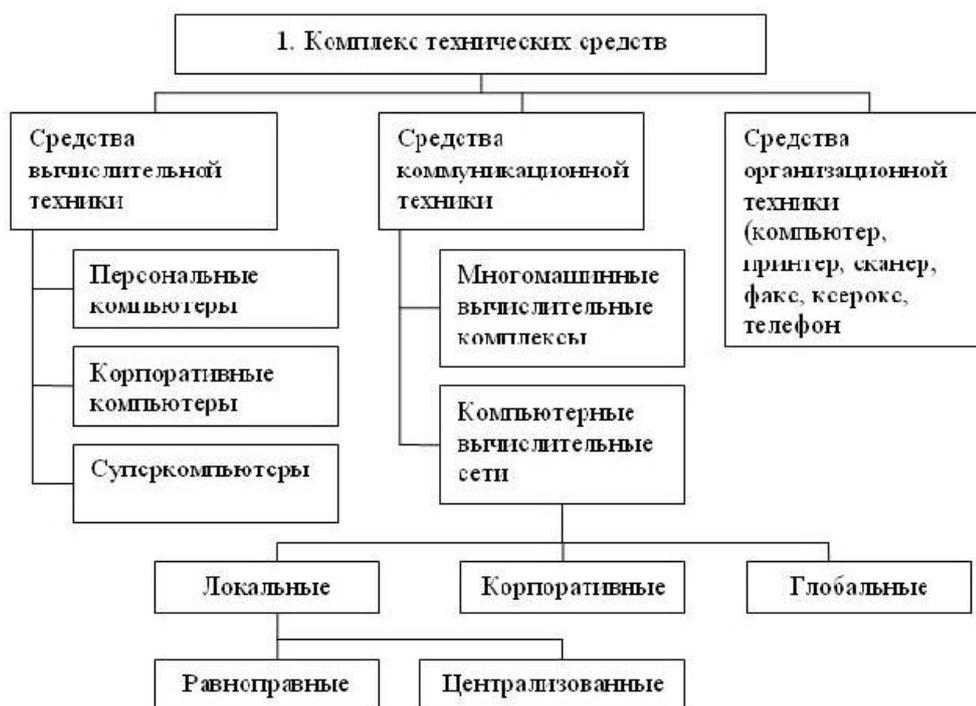
Рисунок 1 - Структура комплекса технических средств АИТ
