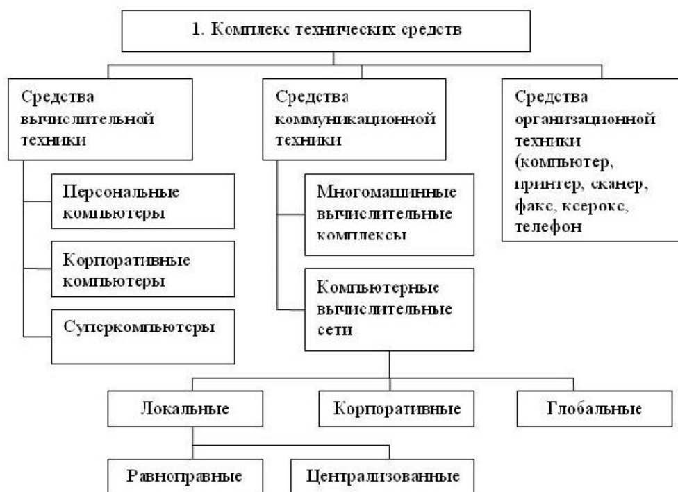
Рисунок 1 - Структура комплекса технических средств АИТ
