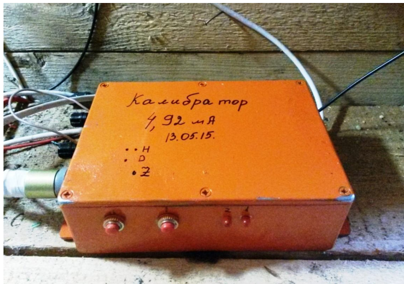
Рисунок 3 – Установленный автоматический калибратор на магнитной станции «Байгазан»
