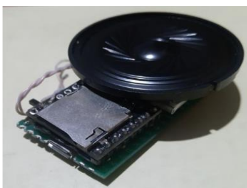
Рисунок 4 – Звуковой модуль собственного производства
