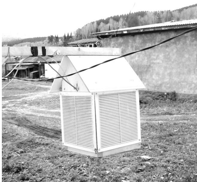
Рисунок 2. Метеобудка прикрепленная к зданию лаборатории робототехники ГАГУ
